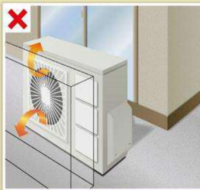
■ 室外機吹出口被遮蔽，造成散熱不良
