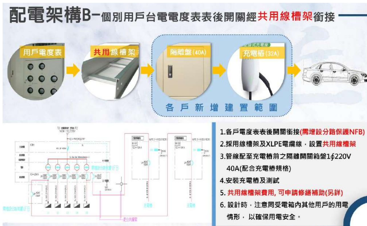
附圖3：【配電架構B-個別用戶台電電度表表後開關經共用線（槽）架銜接】
